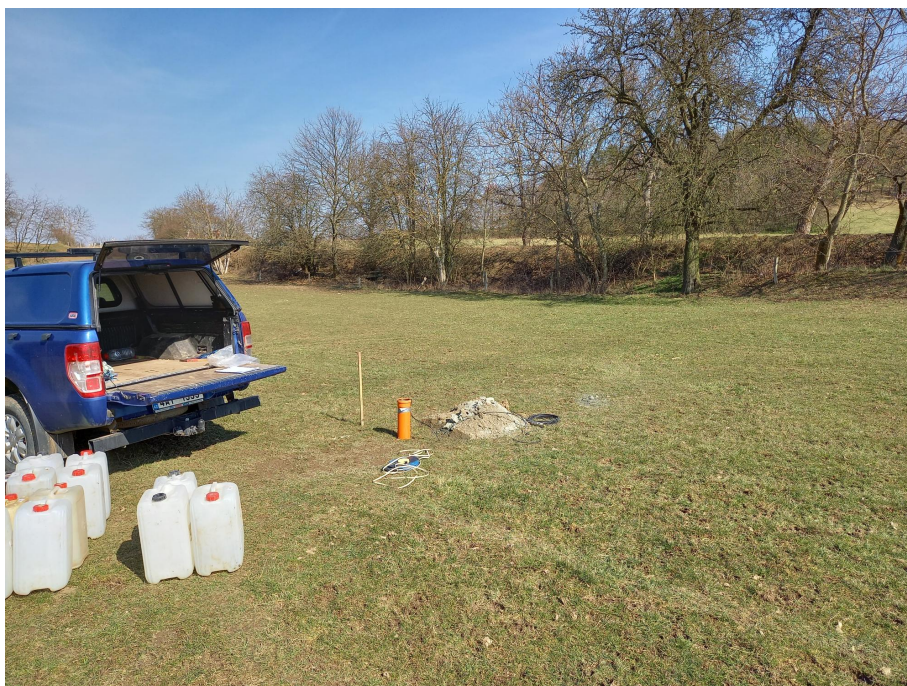
Obrázek 4 – Realizace vsakovací zkoušky ve vrtu JV5
